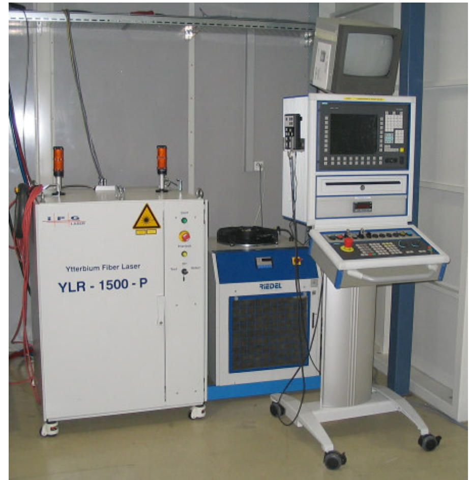
1.5 kW Faser-Laser mit Kühler und CNC-Bedienpult
