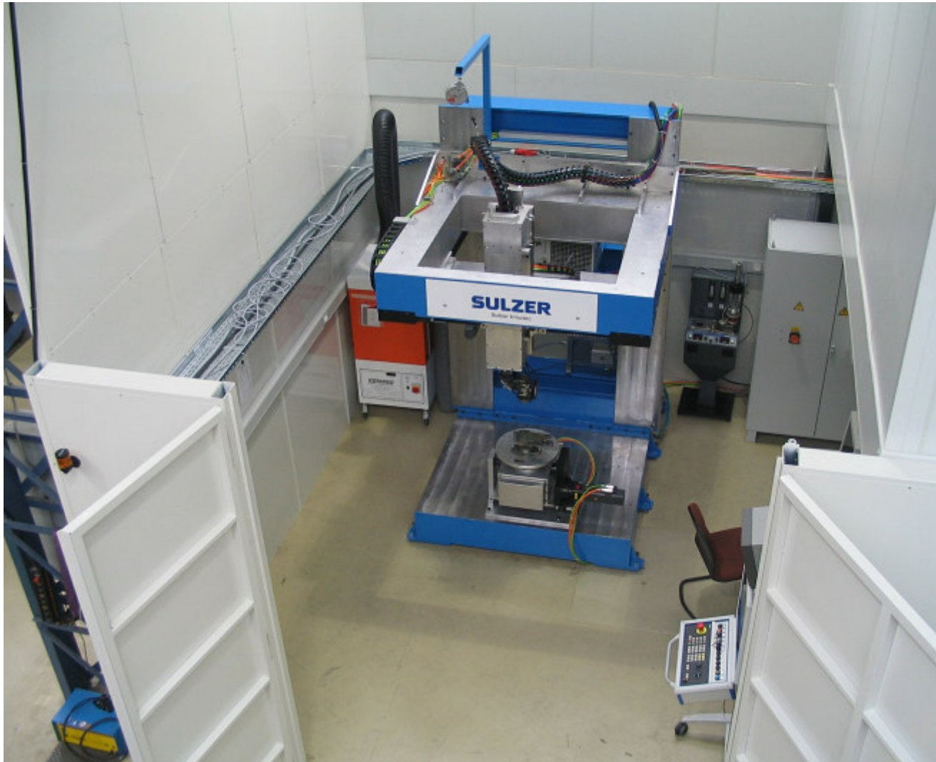
Faser-Laseranlage stationär in ihrer Sicherheits-Einhausung
