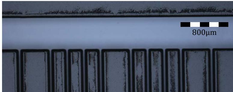
**Abb.10:** Wafer nach Laserstrukturierung
