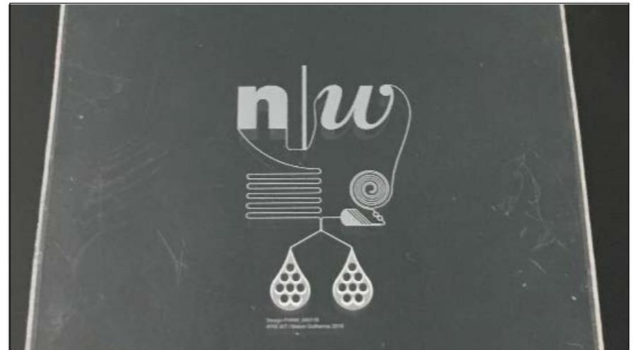
Abb.1: Demo-Chipdesign der FHNW auf PMMA
