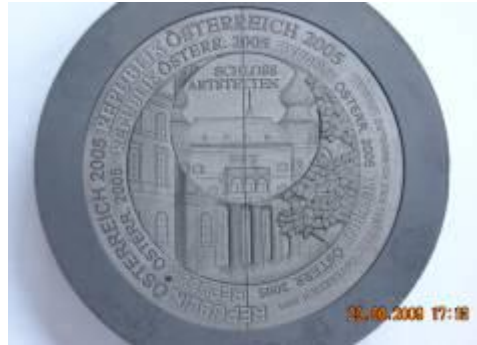
Die ( R_a < 0.3 \mu\text{m} , t = 0.6 \text{ mm} , 35 min)
